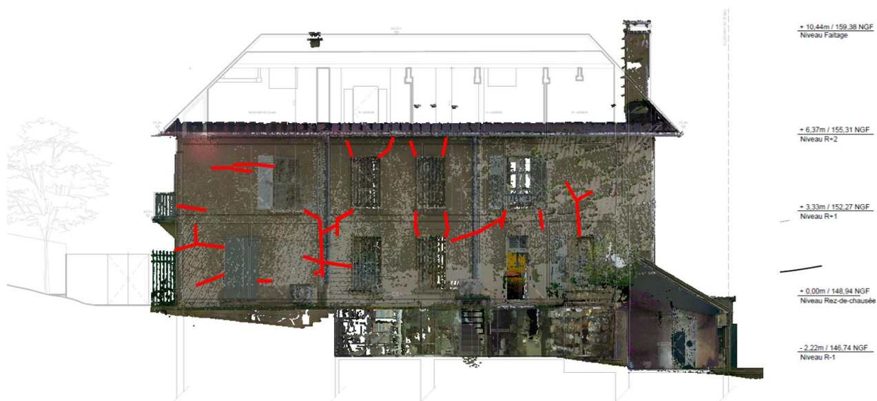
Figure 34. Repérage des fissurations, façade Nord-Est – janvier 2022
