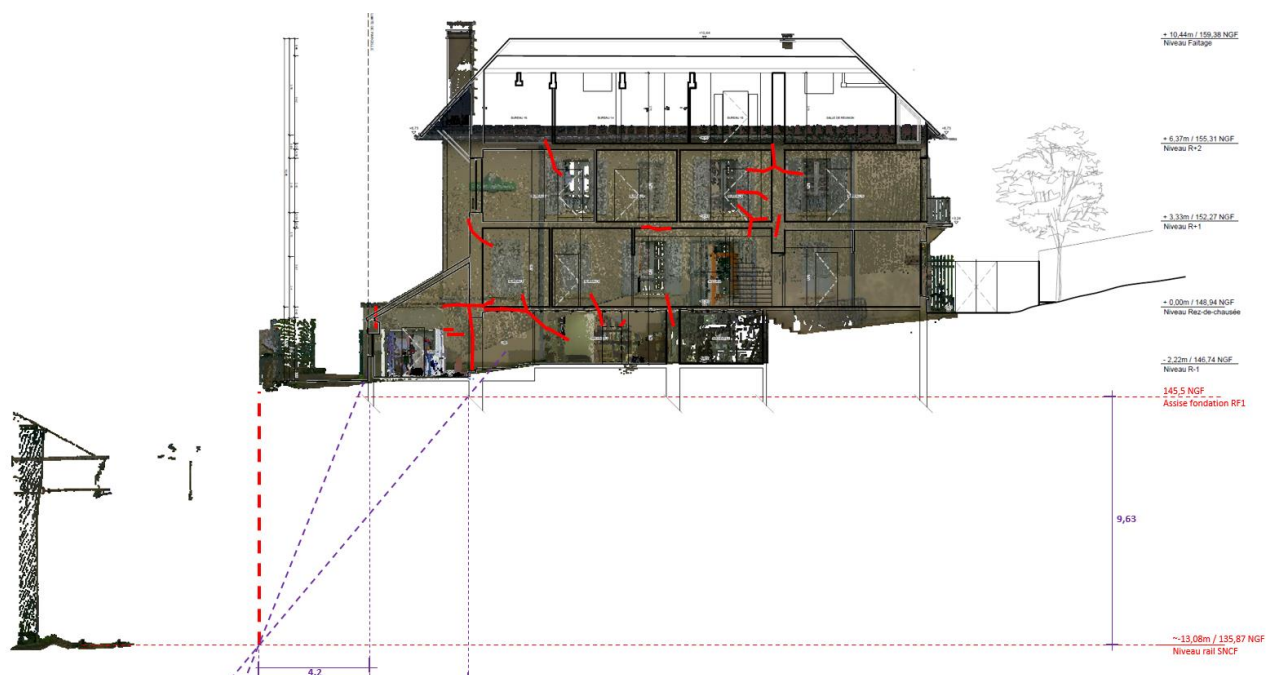
Figure 19. Superposition des coupes existantes et du scan 3D
